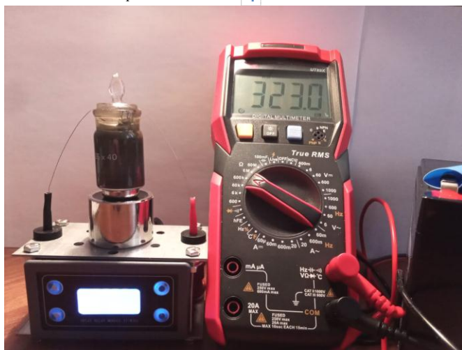
Рис. 2. Лабораторный стенд для исследования влияния магнитного поля на электрические характеристики электропроводящей магнитной жидкости
