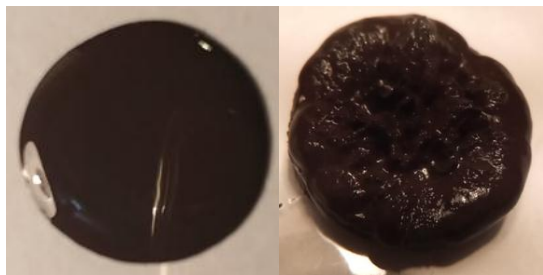
Рис. 1. а). Электропроводящая магнитная жидкость на поверхности стеклянной пластины. б). Электропроводящая магнитная жидкость на поверхности постоянного магнита
