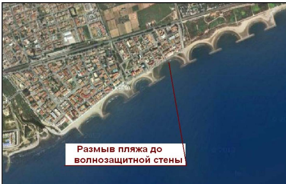
Рис. 1. Песчаные пляжи бухтового очертания с искусственными мысами под защитой волноломов (Франция)
