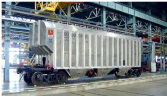
**Рис. 4.** Вагон-хоппер с кузовом из алюминиевого сплава 1565Ч
