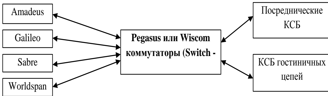
Рис. 3. Схема взаимодействия компьютерных систем бронирования и глобальных распределительных систем через системы переключения
